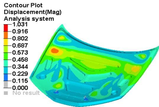
Fig. 24. Mode 3 at 57Hz
