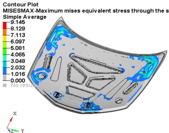
Fig. 18. Von-Mises stress Plot
