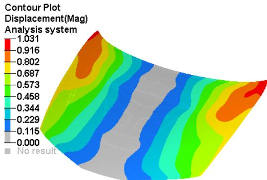
Fig. 23. Mode 2 at 44 Hz
