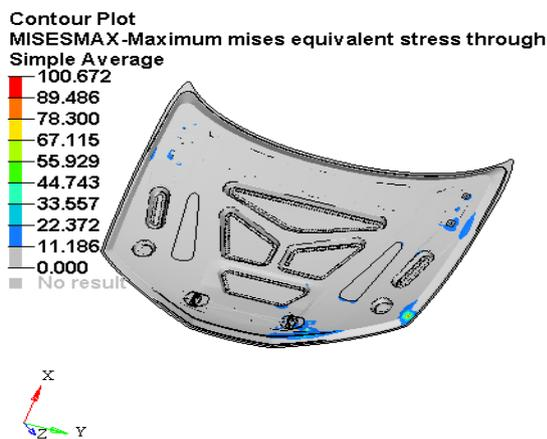
Fig. 20. Von-Mises stress Plot
