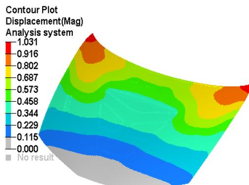
Fig. 22. Mode 1 at 38Hz
